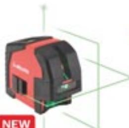
Nivel láser en cruz con plomada, alcance de 30 metros (Laser Clase II), apertura de haz de vertical 180° y haz horizontal 120°, con 2 intensidades de trabajo y autonivelante en superficies inclinadas de hasta 4°. Precisión de 0,3 mm/m y protección IP54 a salpicaduras de líquidos y polvo.
